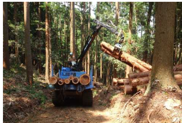
搬出材の積込・運搬
