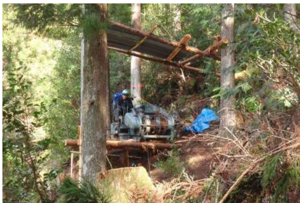
架線集材(集材機)
